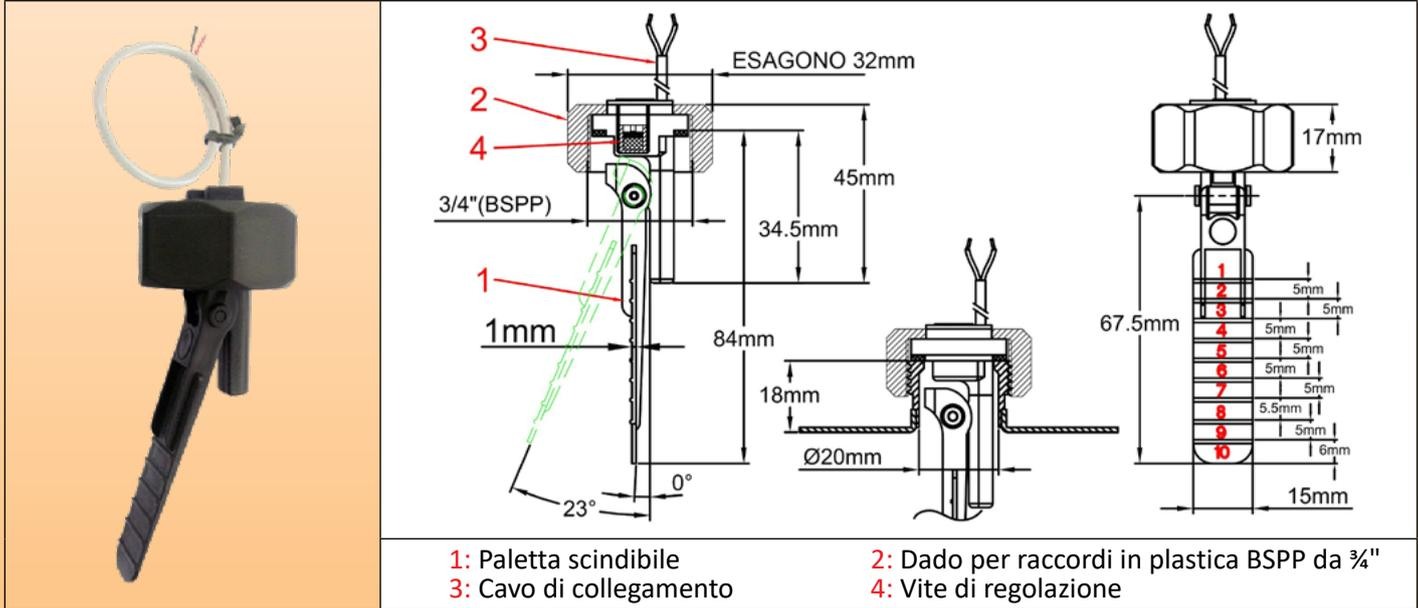
**Principali utilizzi:** Il Flussostato più semplice con ritorno magnetico. La posizione di montaggio consigliata è su tubi orizzontali, ma può essere montato in qualsiasi posizione. Per il rilevamento del flusso d'acqua su tubi di dia. da 25 a 100 mm.
